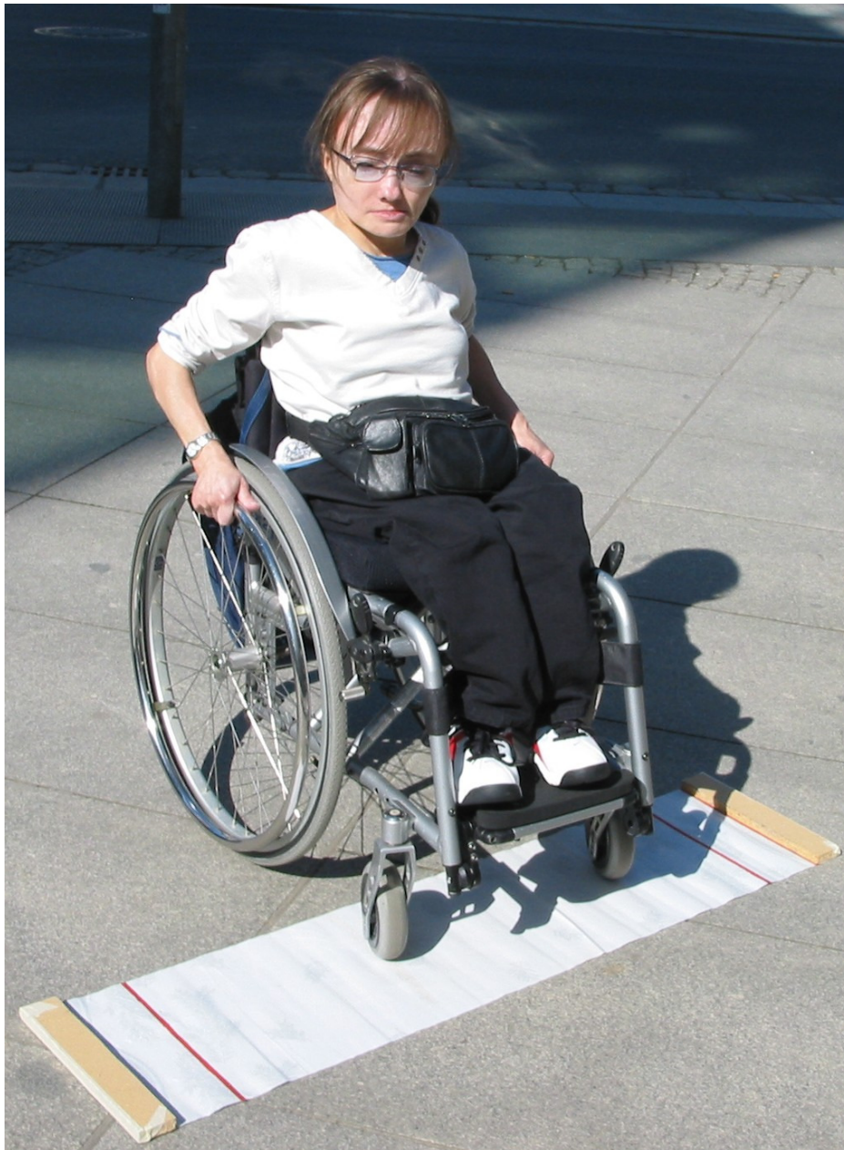
Abb. 5: Die beiden roten Streifen demonstrieren die Breite einer genau 90 cm breiten Nullabsenkung. Bei der vorgeschlagenen seitlichen Verziehung von 30 cm Breite auf 3 cm Bordhöhe wäre der Bord am Beginn der Holzleisten (110 cm Breite) 1 cm hoch, am Ende der Holzleisten (120 cm Breite) 1,5 cm hoch.
