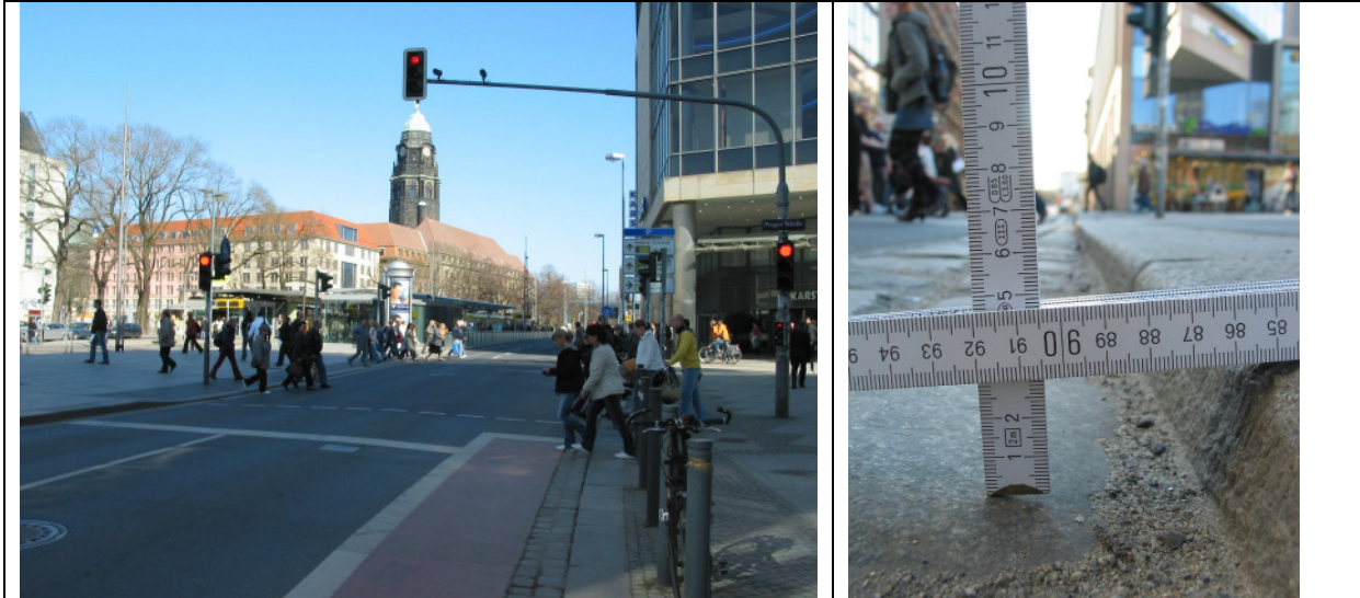
Abb. 3: Die Querungsstelle ist weitgehend barrierefrei gestaltet: a) optimal konzipierte Radfahrstreifen, die vor der Querungsstelle enden; b) eine korrekte, mit geringer Toleranz erbaute Bordsteinkante von ca. 3 cm Höhe;
