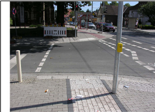
Abb. 11 a: Menschen mit Rollstuhl bzw. Rollator sollten möglichst kreuzungsnah queren. Dies ermöglicht ihnen eine weitgehend geradlinige Bewegung vom Gehweg auf die Straße und weiter zum nächsten Gehweg. Blinde Menschen müssen aus Sicherheitsgründen möglichst kreuzungsfern queren.
